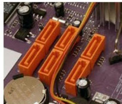
این کانکتورها به **SATA Connector** معروفند . هاردهای سata با تکنولوژی سریال عمل کرده با این تفاوت که از تکنولوژی ساخت پیشرفته تری برخوردارند سرعت بالای انتقال اطلاعات و حجم کمتر این نوع کابلها و سوکت ها از محاسن آن نسبت به IDE ها می باشد. این مادربرد دارای دو عدد سوکت از نوع SATA و دو عدد هم سوکت متداول IDE است و می تواند تا شش عدد Device را پشتیبانی کرده و آدرس دهی کند.
