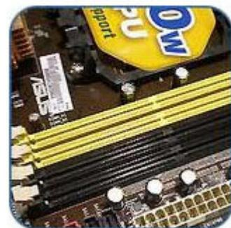
محل نصب RAM است . این اسلات، با دو عدد چفت یا گیره در کنار خود وظیفه نگهداشتن رم را بر عهده دارد. امروزه رم های SD نیز دارای مدل های DDR می باشند و مشخصه ظاهری آنها شیاری که بر روی آن قرار دارد می باشد. اگر بر روی برد رم ، یک شیار وجود داشت رم از نوع DDR است در غیر اینصورت از نوع قدیمی تر ، یعنی SD می باشد.
