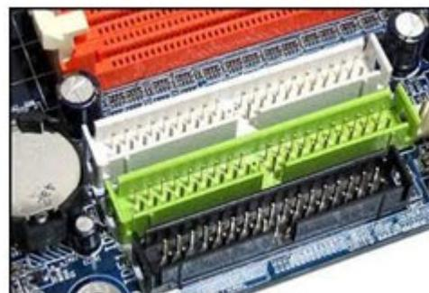
این قسمت محل نصب کابل دیتای هارد و CD ROM می باشد . توجه کنید رنگ متفاوت کانکتور نشان دهنده نوع آن می باشد معمولاً IDE1 به رنگ آبی و اکثرا هارد اصلی سیستم را به آن وصل می کند و IDE2 جهت نصب وسایلی مانند رایتر ، CD Drive و DVD Drive و غیره بکار می رود .
