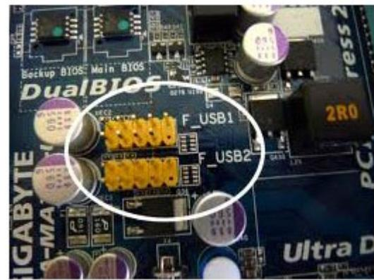
این پورت‌ها به نام **USB** معروف می‌باشند. این پورت‌ها به وسیله کابل‌های کیس به **USB**‌های جلو متصل شده و می‌توان از آنها استفاده کرد.
