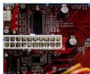
قسمت بعدی کانکتور پاور ( منبع تغذیه ) می باشد . همانگونه که در شکل مشخص است دو عدد کانکتور ولتاژ ، از پاور به مادربرد متصل می شود . این دو کانکتور یکی بزرگ و مستطیل شکل و دیگری کوچک و مربع شکل می باشد ( کانکتور ۱۲ ولت مادربرد ) . وظیفه این دو کانکتور انتقال ولتاژ از پاور به مادربرد است .
