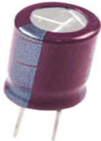
در خازن‌های الکتروولیت معمولی را برطرف کرده‌اند ساختمن این دو نوع خازن تا حد زیادی شبیه به هم است . مهمترین تفاوت میان خازن‌های حالت جامد و خازن‌های الکتروولیت معمولی ، در ماده الکتروولیت به کار رفته در آنها است . ورقه جدا کننده در خازن‌های معمولی از یک صفحه کاغذی که به ماده الکتروولیت آخسته شده است تشکیل شده در حالی که در خازن‌های حالت جامد ورقه جدا کننده از ترکیب ماده الکتروولیت با یک پلیمر رسانا تشکیل می‌شود .
