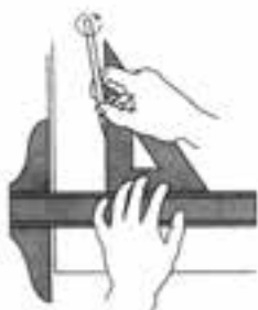
نحوه خط کشی روی لبه گونیا با مداد در جهت قائم
