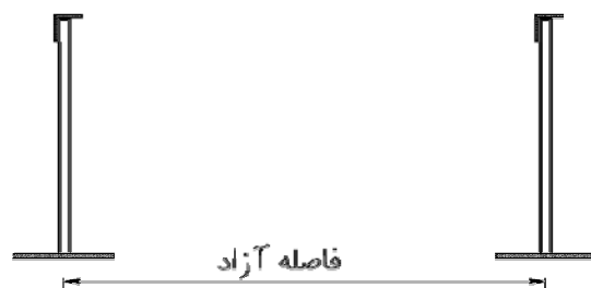
شکل ۲-۸- فاصله‌ی آزاد بین تیرچه‌های فولادی
