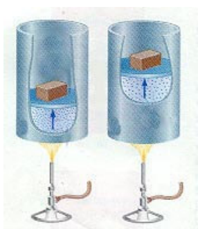
شکل ۳-۵. بالا رفتن پیستون و وزنه روی آن در اثر حرارت دادن به سیلندر
