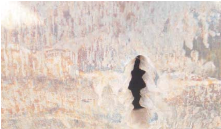
شکل فوق یک لوله حفاری Wash-Out شده را نشان می دهد.
