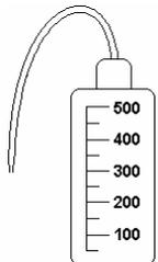
(۲۴) - پیست (آبفشان): از این وسیله رایج آزمایشگاهی بیشتر برای نگهداری آب مقطر و محلول های رقیق استفاده می شود که با فشار دادن مخزن پلاستیکی قابل انعطاف آن، آب از لوله خمیده خارج می شود.
