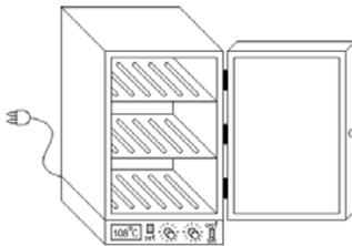
(۵۰) - آون (اتوکلاو) : از این دستگاه بیشتر برای خشک کردن مواد و ظروف آزمایشگاهی توسط گرما و نیز حرارت دادن یکنواخت ظروف حاوی نمونه های آزمایشگاهی استفاده می شود.
