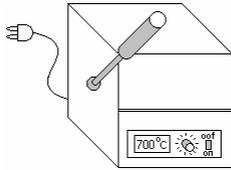
(۴۸) - کوره الکتریکی : از این دستگاه برای گرم کردن شدید و سوزاندن کامل مواد و نیز ذوب کردن برخی از فلزات استفاده می شود و رایج ترین نوع آن می تواند مواد مختلف را تا حدود  $1200^{\circ}\text{C}$  گرم کند که در هنگام کار با این دستگاه باید توجه داشت تا درب آن زیاد باز نماند زیرا در این حالت حرارت تولید شده داخل آن به سرعت خارج می شود .
