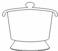
(۱۷) - دسیکاتور (خشکانه) : از این وسیله که شبیه یک قابلمه بزرگ شیشه ای است بیشتر برای گرفتن رطوبت و خشک کردن مواد استفاده می شود و چون این وسیله رطوبت موجود در مواد را توسط مواد جاذب الرطوبه ای مانند کلرید کلسیم و یا اسید سولفوریک غلیظی که در ظرف پایین آن قرار دارد جذب می نماید پس نباید درب آن را به مدت طولانی باز گذاشت زیرا در غیر این صورت رطوبت موجود در محیط آزمایشگاه جذب مواد جاذب الرطوبه آن شده و موجب کاهش کارآیی دستگاه می شود .
