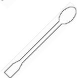
(۲۶) - اسپاتول (قاشقک آزمایشگاهی) : از این وسیله برای خرد کردن و برداشتن مواد جامد استفاده می شود که دارای دو نوع چینی و فلزی می باشد .
