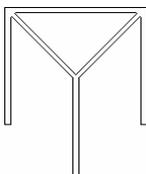
(۳۴) - سه پایه : از این وسیله بیشتر برای نگه داشتن توری نسوز و مثلث نسوز بر روی شعله چراغ بونزن استفاده می شود که چراغ بونزن هم در زیر آن قرار می گیرد .
