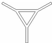
(۳۳) - مثلث نسوز : از این وسیله که بر روی سه پایه آزمایشگاهی قرار می گیرد بیشتر برای نگه داشتن ظروف آزمایشگاهی و به خصوص کروزه چینی بر روی شعله مستقیم چراغ بونزن استفاده می شود .
