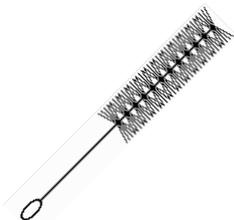
(۲۵) - لوله شوی : از این وسیله برای شستن و تمیز کردن جداره داخلی ظروف آزمایشگاهی نظیر لوله آزمایش ، ارلن ، بالن ، بشر و ... استفاده می شود .
