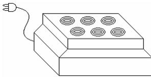
(۴۹) - حمام آبگرم : از این دستگاه که داخل مخزن آن همواره مقدار معینی آبگرم قرار دارد برای گرم کردن ملایم و یکنواخت ظروف حاوی مواد شیمیایی استفاده می شود .
