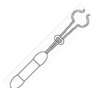
(۳۶) - گیره لوله آزمایش : از این وسیله برای جابه جایی لوله آزمایش و به خصوص نگه داشتن آن در هنگام گرما دادن استفاده می شود .
